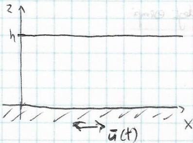
In questo caso il fluido visco-ircomprimibile poggia sul solido piano oscillante con velocità
